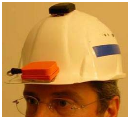
Εικόνα 2.2: Παράδειγμα τοποθέτησης συστήματος στο κεφάλι του χρήστη
