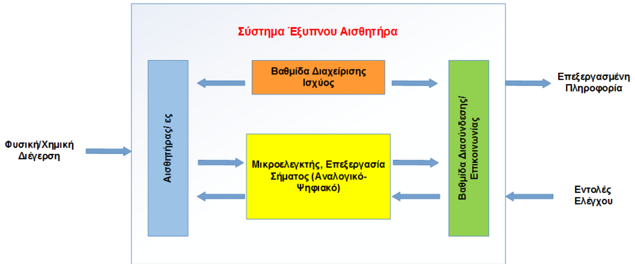
Σχήμα 2: Σύστημα Έξυπνου Αισθητήρα
