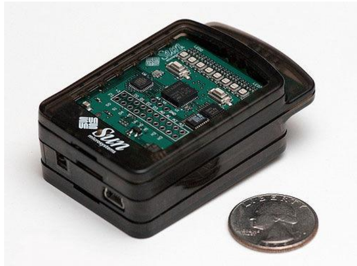
Εικόνα 3: Συσκευή Sun SPOT της Sun Microsystems.
