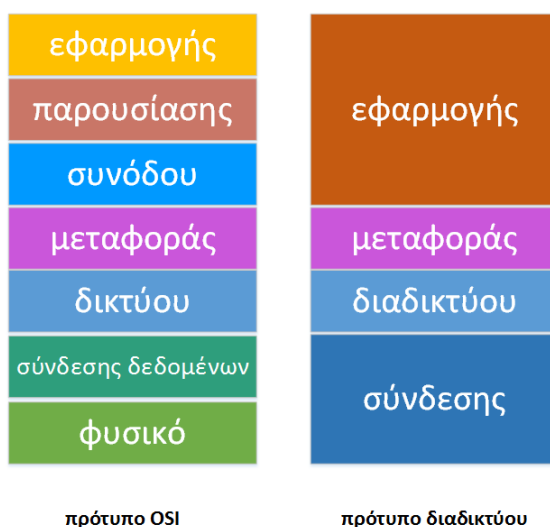
Σχήμα 20: Τα πρότυπα OSI και διαδικτύου για τη στρωματική μοντελοποίηση δικτύου.
