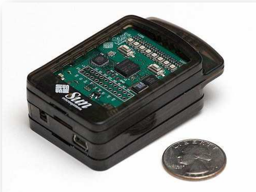
Εικόνα 2: Μια συσκευή SunSPOT
