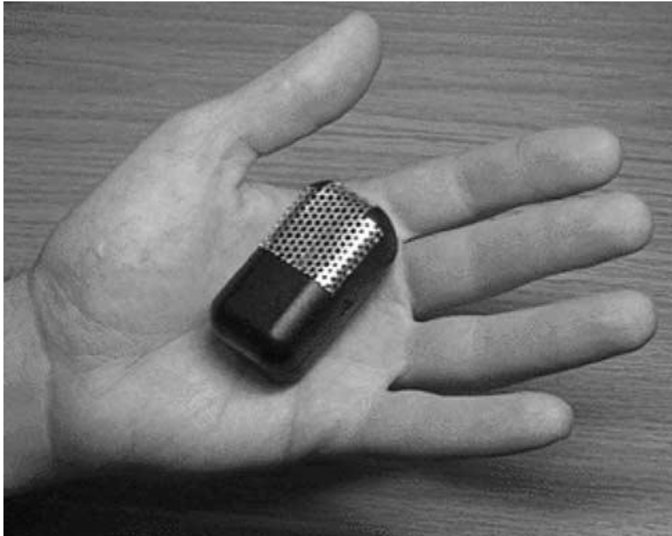
Εικόνα 1: Μία μονάδα για εντοπισμό θέσης τύπου Bat
