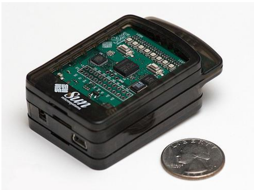
Εικόνα 1: Ασύρματος προγραμματιζόμενος αισθητήρας SunSPOT από τη Sun Microsystems
