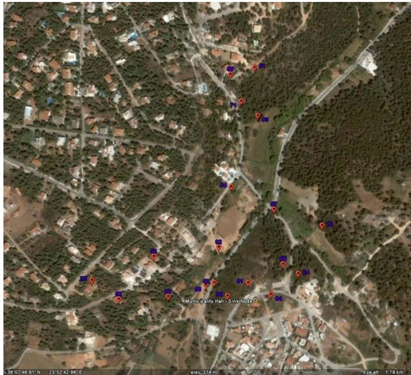
Εικόνα 3: Ασύρματο δίκτυο αισθητήρων για παρακολούθηση πυρκαγιάς σε πραγματικό χρόνο
