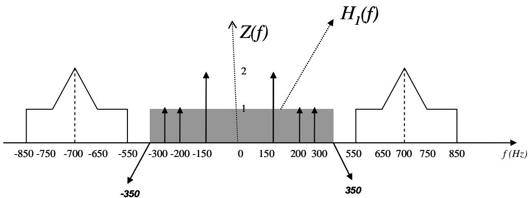
c/ Με βάση την εκφώνηση για το σήμα εξόδου: *αποτελείται από το άθροισμα δύο ημιτονικών σημάτων με περίοδο 1/100sec.* Επόμενως ψάχνουμε να βρούμε ποιό από τα 3 δυνατά ζευγάρια (150, 200), (150, 300), (200, 300) έχει περίοδο 1/100sec.
