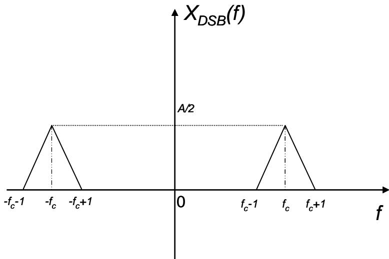
Για να πάρουμε το SSB κάτω πλευρικής θα χρησιμοποιήσουμε ιδανικό ζωνοπερατό με κεντρική συχνότητα  $\pm\left(f_c - \frac{1}{2}\right)$  και εύρος ζώνης  $W=1$ , όπως φαίνεται στο πιο κάτω σχήμα.
